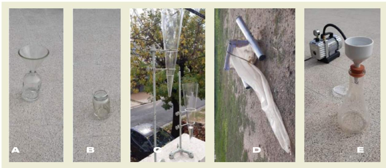
**Figura 1. Muestreadores de MP atmosférico (en transporte y deposición) testeados y/o utilizados en este estudio; a) vaso de precipitado + embudo de 13 cm de diámetro; b) vaso de precipitado + embudo de 7,5 cm de diámetro; c) conos de Imhoff; d) red tipo Manta (sin el trípode); e) bomba de vacío y Kitasato.**
